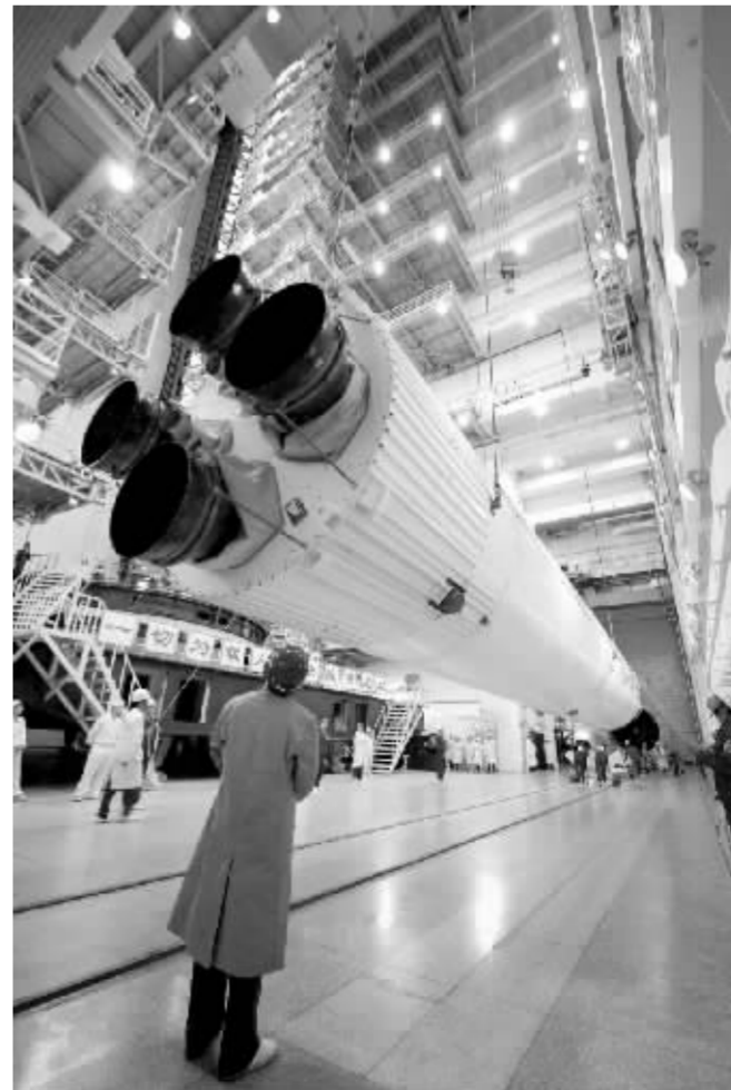
在垂直总装测试厂房,运载火箭一级正在进行吊装 资料图
