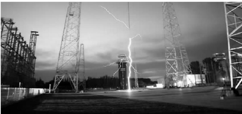
国家电网公司特高压直流试验基地进行空气间隙试验 资料图
