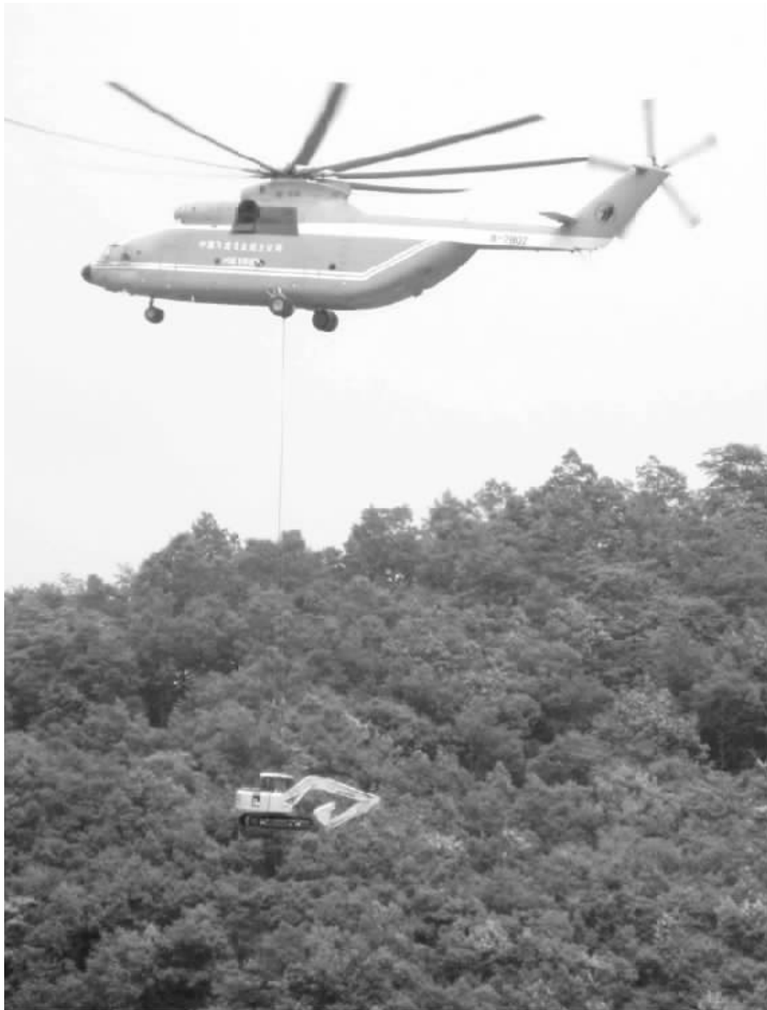
米-26直升机在向唐家山堰塞湖坝顶吊运挖掘机 新华社图
