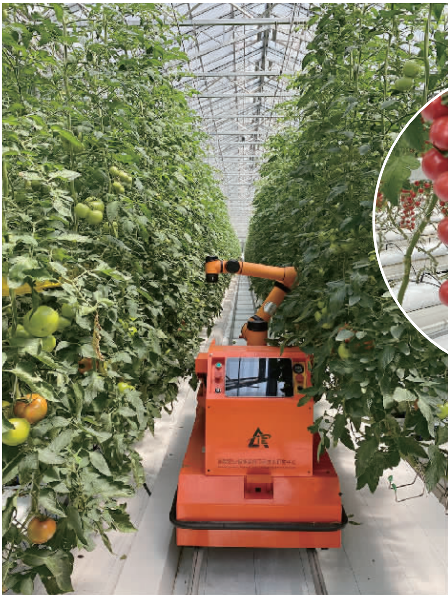
在中国（寿光）蔬菜小镇的新型温室大棚内，机器人根据色彩感知度等自动摘收西红柿
