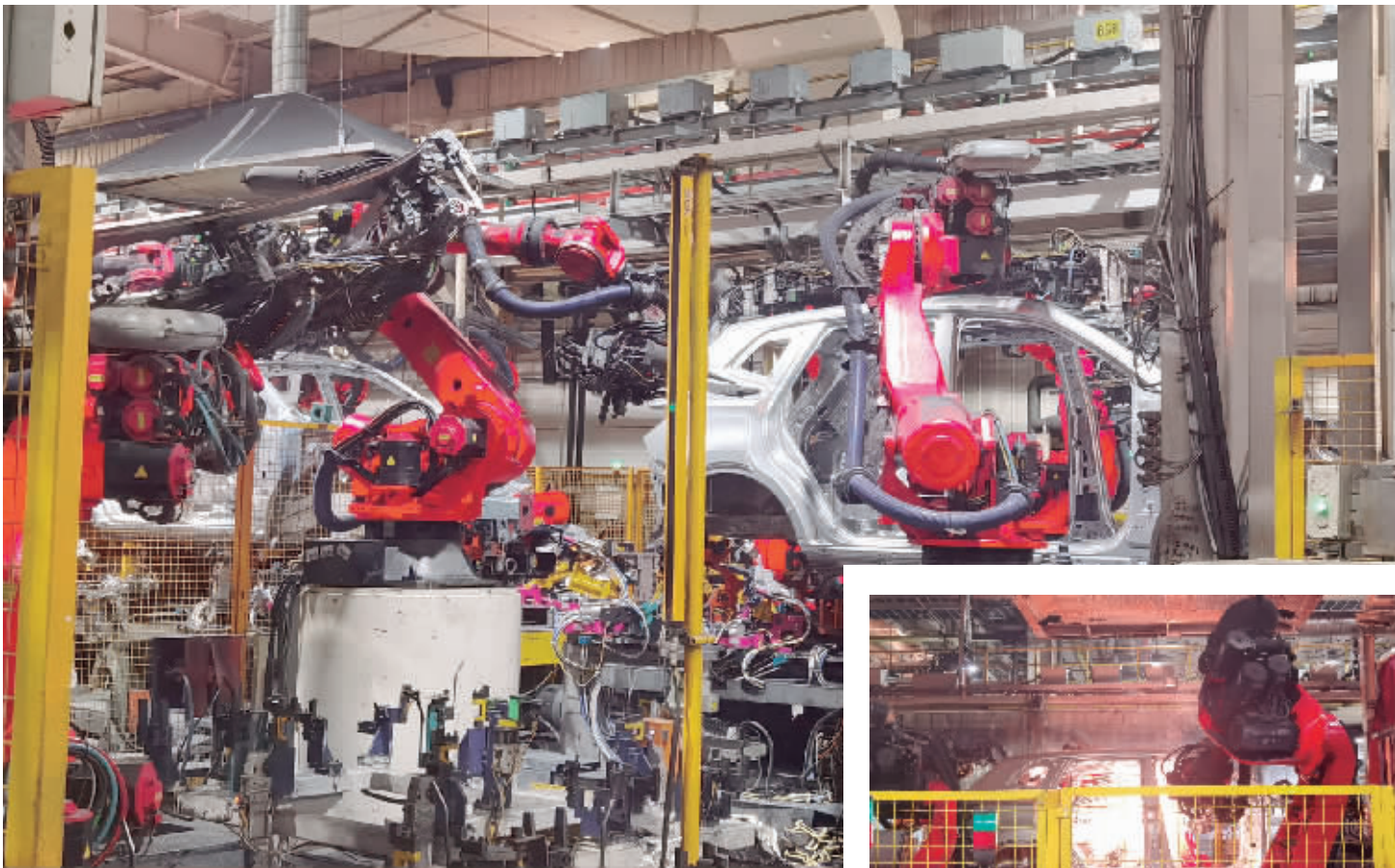
上汽乘用车上海临港基地新能源汽车车身自动化生产线(上)、自动化焊接生产线
