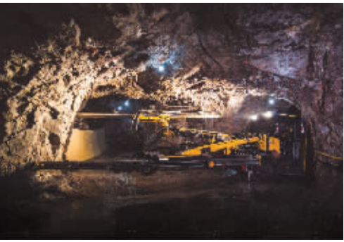
山东黄金井下大型化机械—双臂岩台车作业场景
