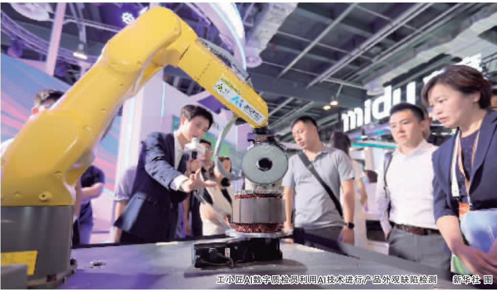
工小匠AI质检员利用AI技术进行产品外观缺陷检测 新华社 图
