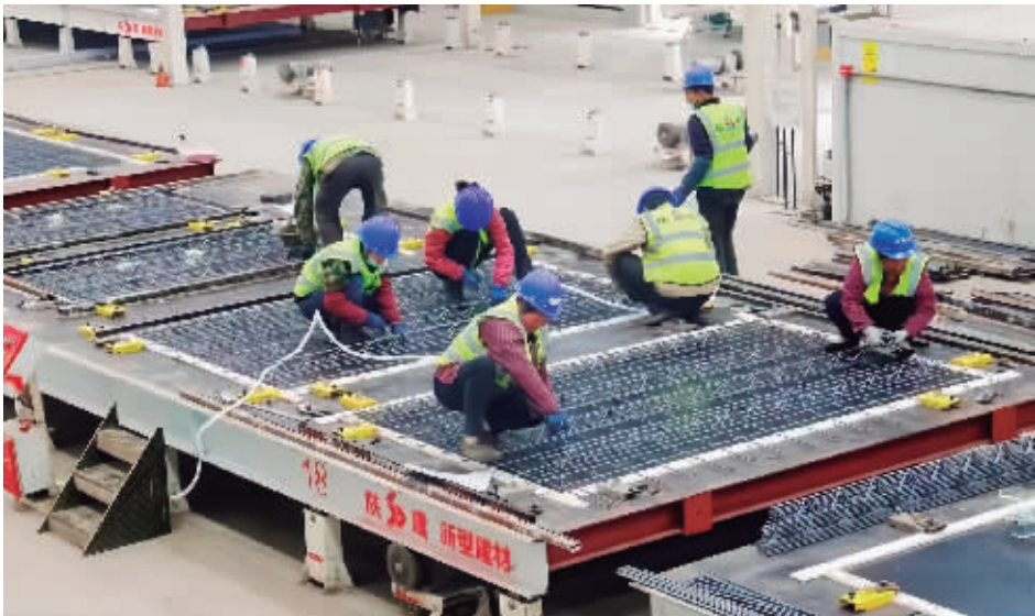
陕建新型建材工人在生产预制叠合板
