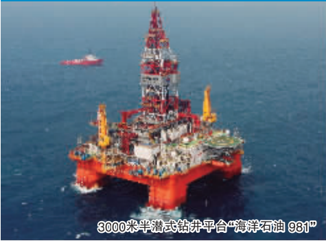
3000米半潜式钻井平台“海洋石油981”
