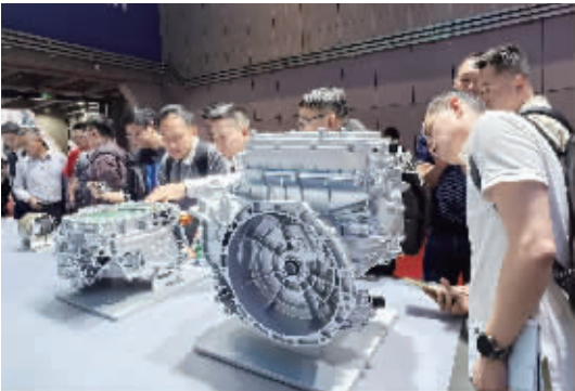
汇川联合动力展示的第五代高压电驱五合一总成。
