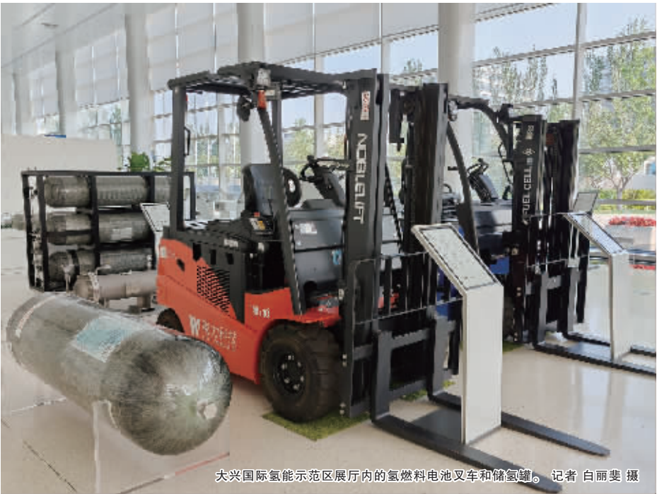
大兴国际氢能示范区展厅内的氢燃料电池叉车和储氢罐。 记者 白丽斐 摄
