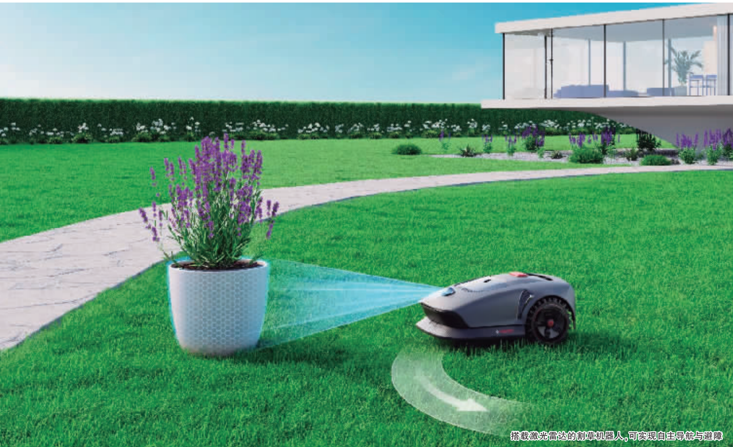
搭载激光雷达的自动驾驶机器人,可实现自主导航与避障
