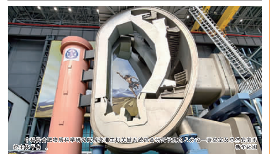
中科院合肥物质科学研究院聚变堆主机关键系统综合研究设施的一部分真空室及总体安装系统综合平台。
