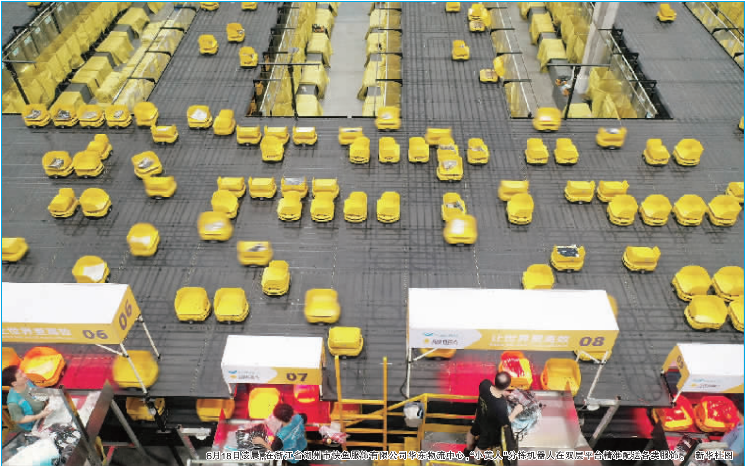
6月18日凌晨,在浙江省温州市钱鱼服饰有限公司华东物流中心,“小黄人”分拣机器人在双层平台精准配送各类服饰。(新华社图)
