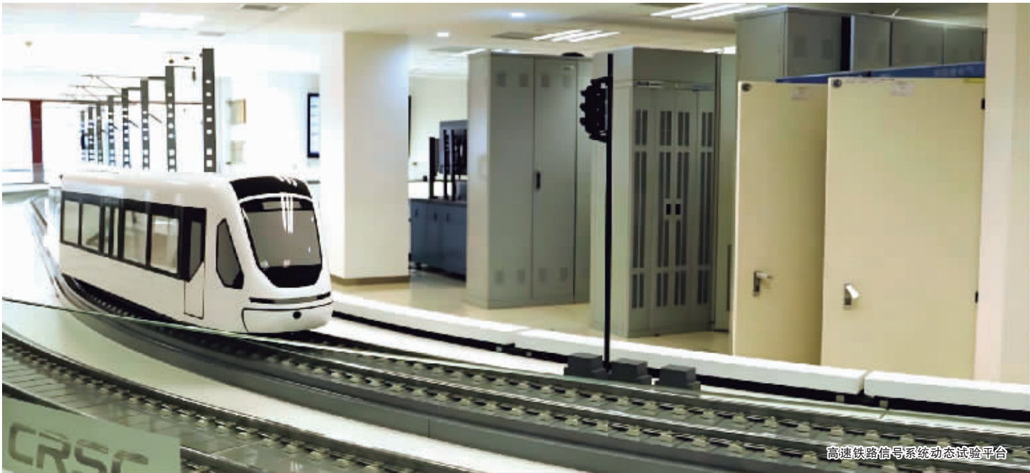
高速铁路信号系统动态试验平台
