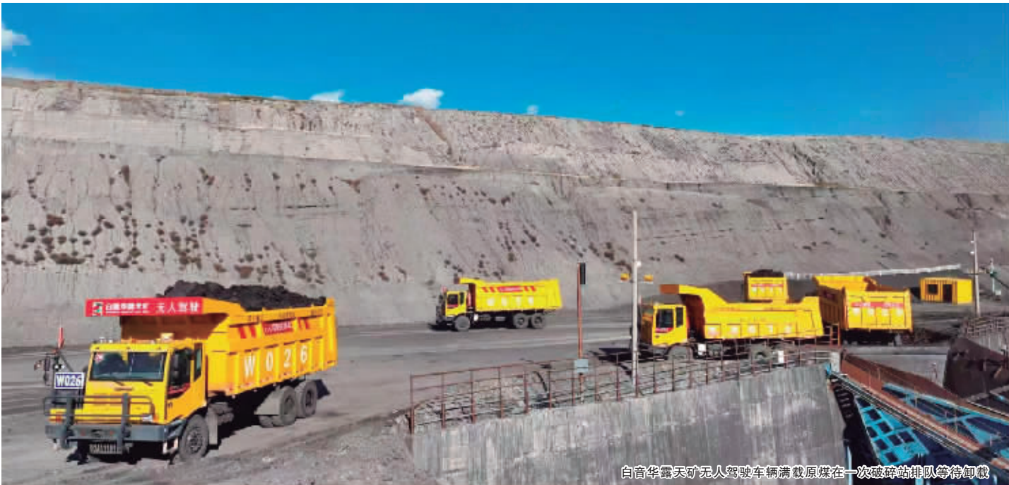
白音华露天矿无人驾驶车辆满载原煤在一次破碎站排队等待卸载
