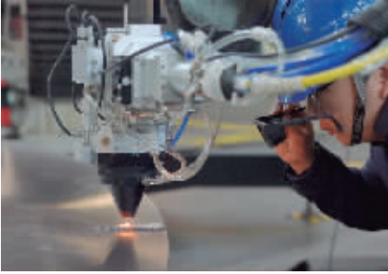
东方电气员工察看转轮机器人焊接增材制造运行情况
