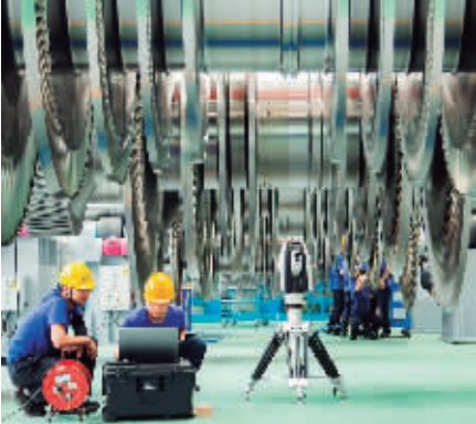
东方电气员工用数字化检测手段进行转子装配
